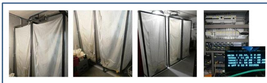
***Moduli insettiere per l’allevamento di *Hermetia illucens* realizzati presso l’Az. Agr. Sper. Stuard, con PLC per il controllo remoto dei parametri ambientali dell’allevamento***
