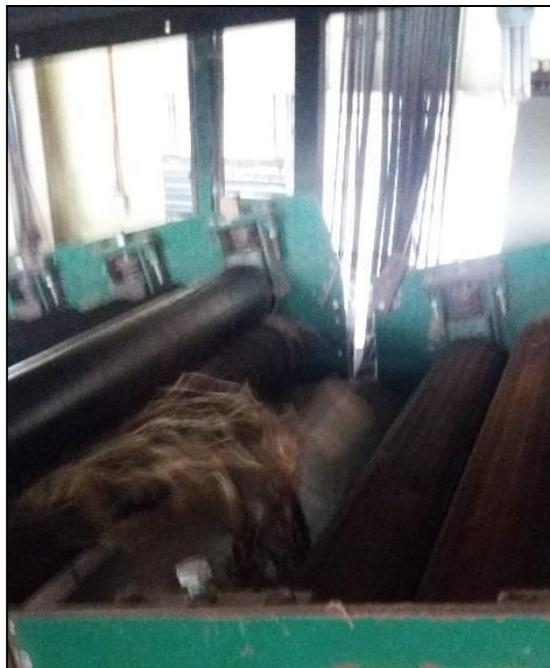
Le rotoballe vengono aperte e i fusti, disposti su un nastro trasportatore, vengono convogliati nella macchina stigliatrice che mediante l'azione di rulli e tamburi determina la separazione del **tiglio** (parte esterna fibrosa) dal **canapulo** (parte interna del fusto lignificata). Il tiglio viene raccolto e nuovamente pressato in balle.
